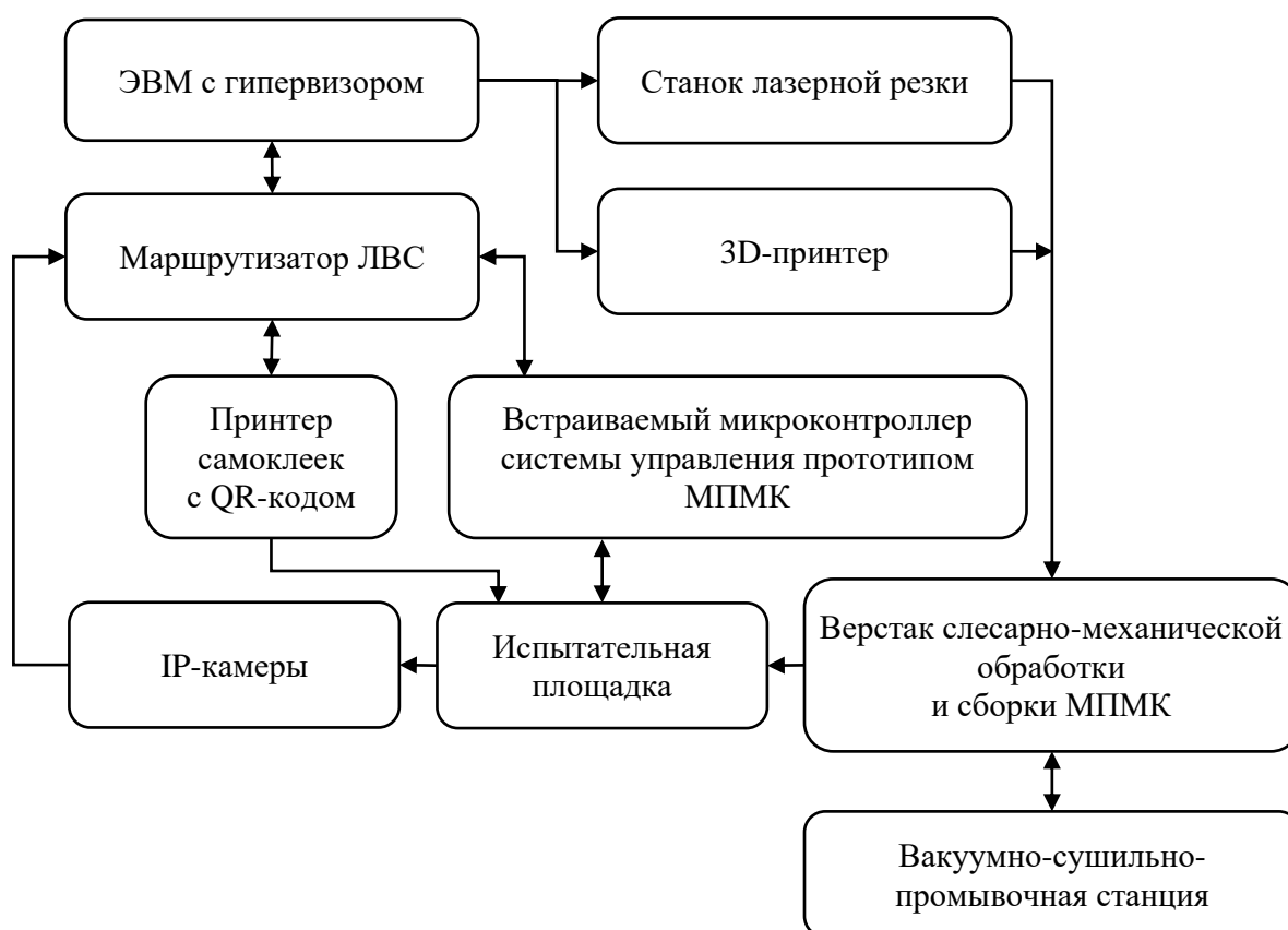
Рис. 3. Схема экспериментальной лабораторной системы для исследования процессов САППИУ и разработки ИПК МПМК
