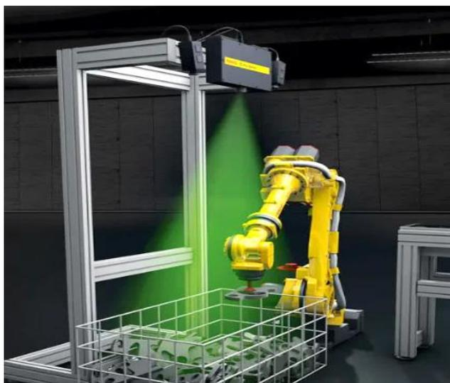
*Рис. 2. Использование системы IRVision в операции сбора<sup>4</sup>*
