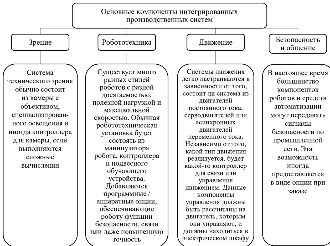
*Рис. 1. Компоненты интегрированных производственных систем*
