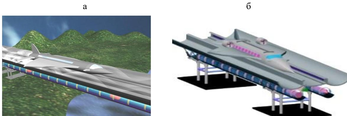
**Рис. 3.** а – фрагмент формирования потока воздуха из-под экранолета на эстакаде; б – расположение электровентиляторных двигателей над крылом и под крылом и фюзеляжем<sup>1</sup>
