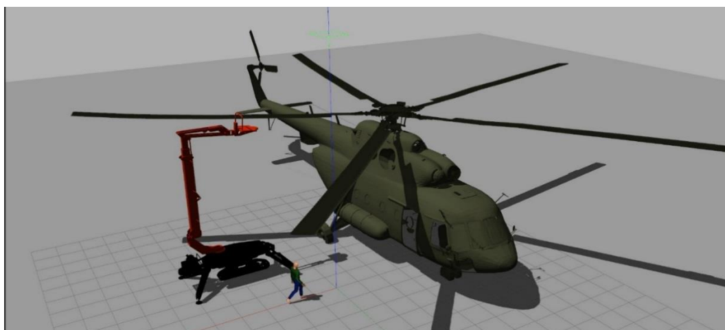
Рис. 3. Симулятор с коллаборативной ячейкой, оператором и фюзеляжем вертолета
