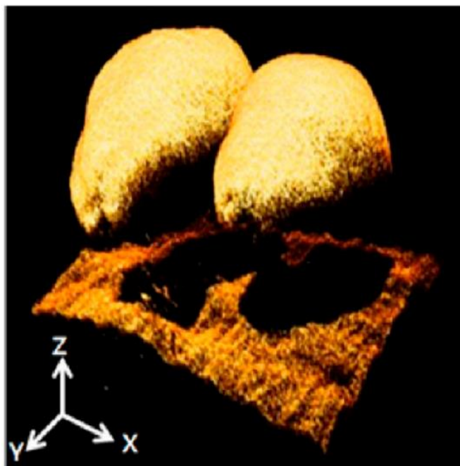
Рис. 3. 3D-реконструкция семян дыни, основанная на данных, полученных при интерферометрии
