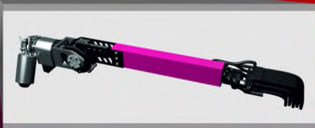
Манипулятор с многодиффузорной моющей насадкой на двухкоординатном шарнире
